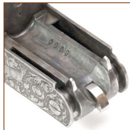
Илл. 6а. В отличие от унитарного рычага, раздельные взводители курков продолжают обеспечивать функционирование оружия в случае поломки элементов взводящего механизма или одного из замков
