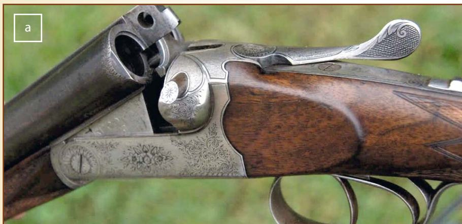
Илл. 3. Затворная система Егера со своими плюсами и минусами получила распространение только у германских и бельгийских оружейников
