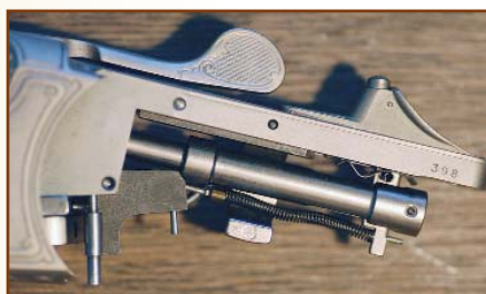
Илл. 5. Модифицированный взводитель Ф. Егера ( Separate Kugel-Handspannung ) в современной модели K 770 фирмы Blaser Jagdaffen GmbH
