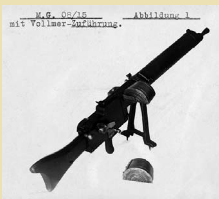
Пулемёт MG 08/15 с системой безленточной подачи боеприпасов Фольмера. Немецкие военные мечтали о таком пулемёте, так как применяемые в то время холщовые патронные ленты намокали во время дождя, что приводило к задержкам при стрельбе. Фото: Vollmer Werke
