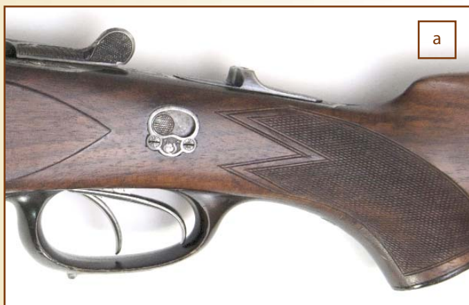
Илл. 4. Механизм отдельного взвода пружины ударника для нарезного ствола, изобретённый Ф. Егером, без принципиальных конструктивных изменений используется ровно 105 лет!
