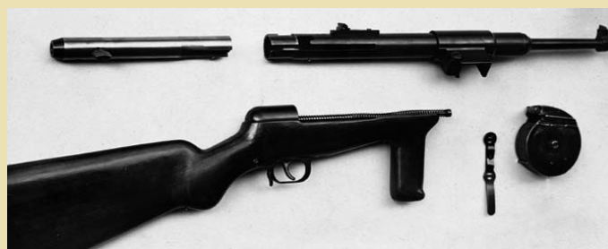
Пистолет-пулемёт VMP в собранном и разобранном виде. Фото: Vollmer Werke
