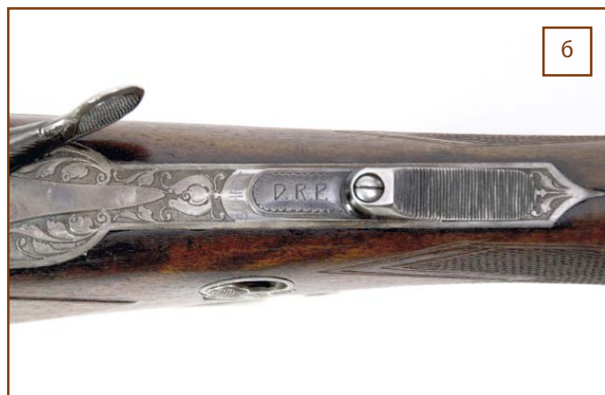
Илл. 4. Механизм отдельного взвода пружины ударника для нарезного ствола, изобретённый Ф. Егером, без принципиальных конструктивных изменений используется ровно 105 лет!
