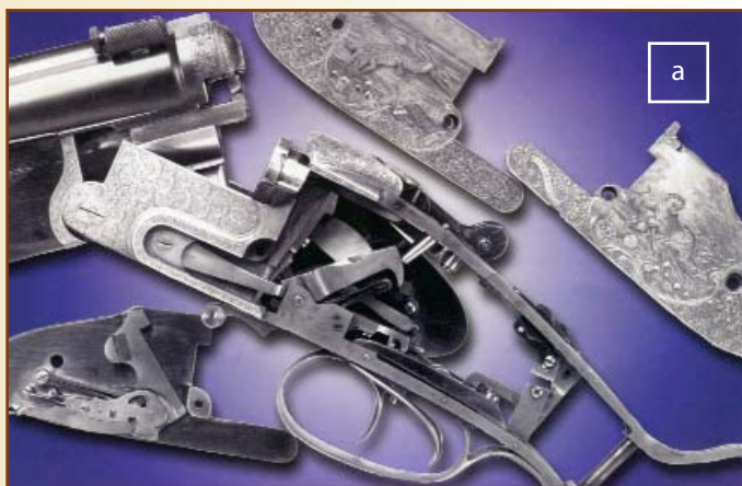
Илл. 9. Один из шедевров конструкторской мысли – тройник Ф. Егера с вертикальным затвором, обеспечивающим полную разгрузку коробки от осевых сил в момент выстрела
